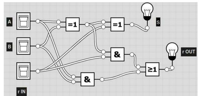
**4. Circuit additionneur n bits :**
